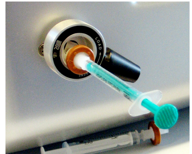
Figuur 19. Injecteren van vloeistof vanaf de buitenkant
