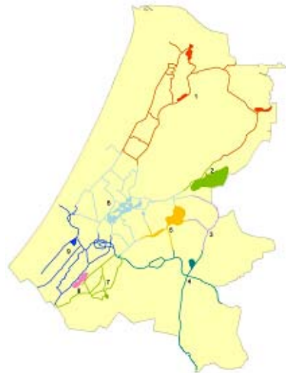
Figuur 15 Boezemcompartimentering in HLM met behulp van BWO's (N&S Consultants, 2004)
