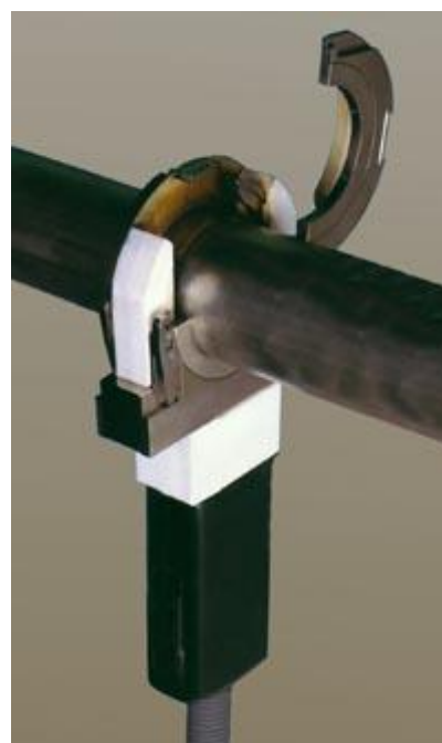
1.2.2.b, c Voorbeelden van orbitale lasmachines, bestaand uit een stroombron met daarop de interface en een laskop 5
