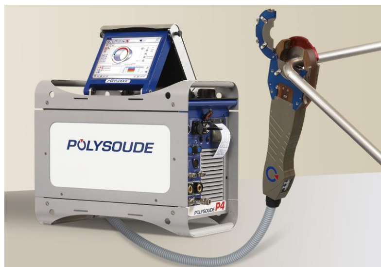
1.2.2.b, c Voorbeelden van orbitale lasmachines, bestaand uit een stroombron met daarop de interface en een laskop 5
