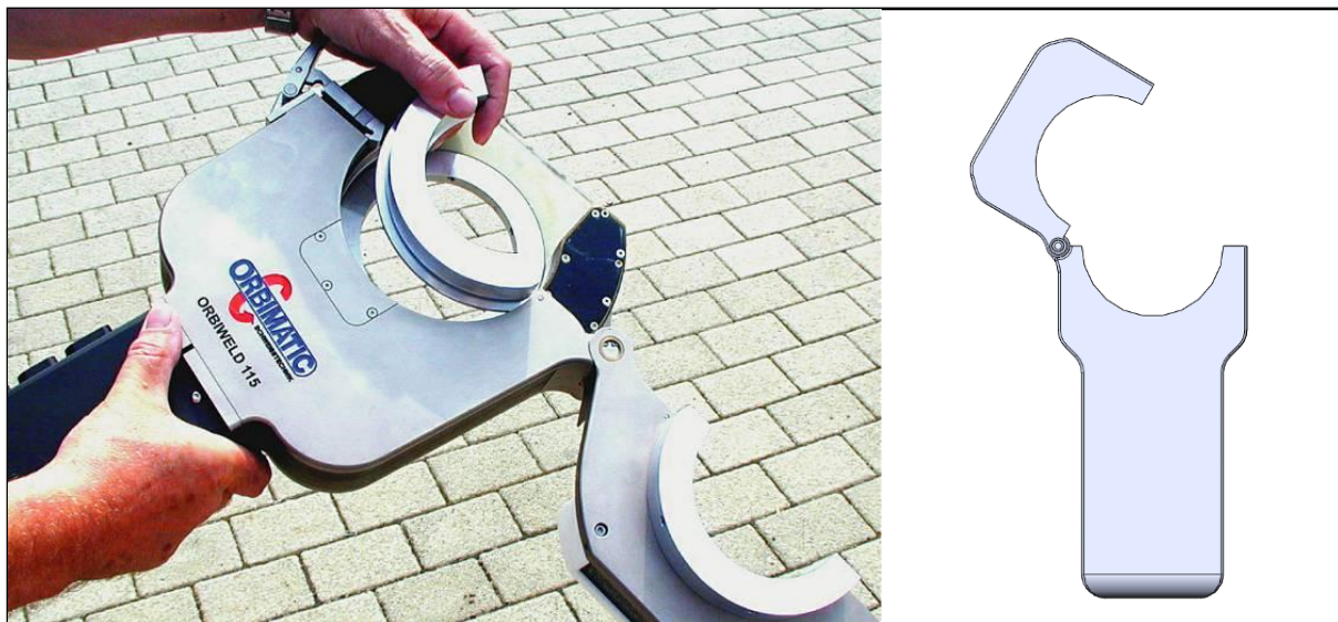
2.2.k Het handmatige sluitingsmechanisme bij een laskop van Orbimatic 14 .
