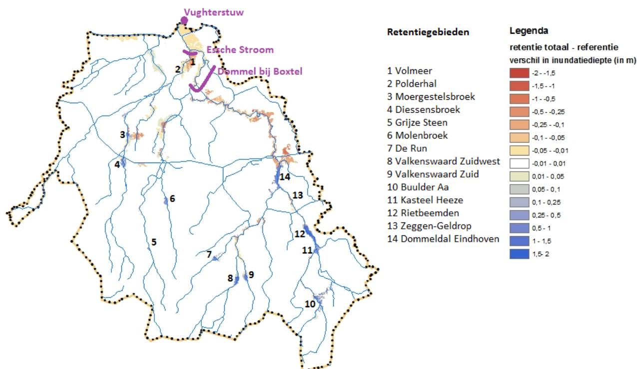
Figuur 4-12: De inundatieverschillenkaart met paars de primaire meetpunten, genummerd de retentiegebieden en van rood naar blauw het verschil in inundatiediepte.
