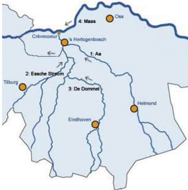
Figuur 2-1: De aankomst van de hoogwatergolven bij 's-Hertogenbosch, met nummers is de volgorde aangegeven. Vrij naar: www.brabantsewaterkaart.nl .
