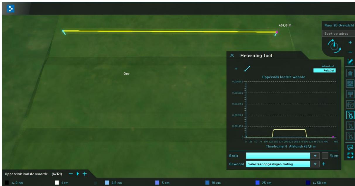
Figuur 23: Waterdiepte op maaiveld 5 minuten na begin regenbui
