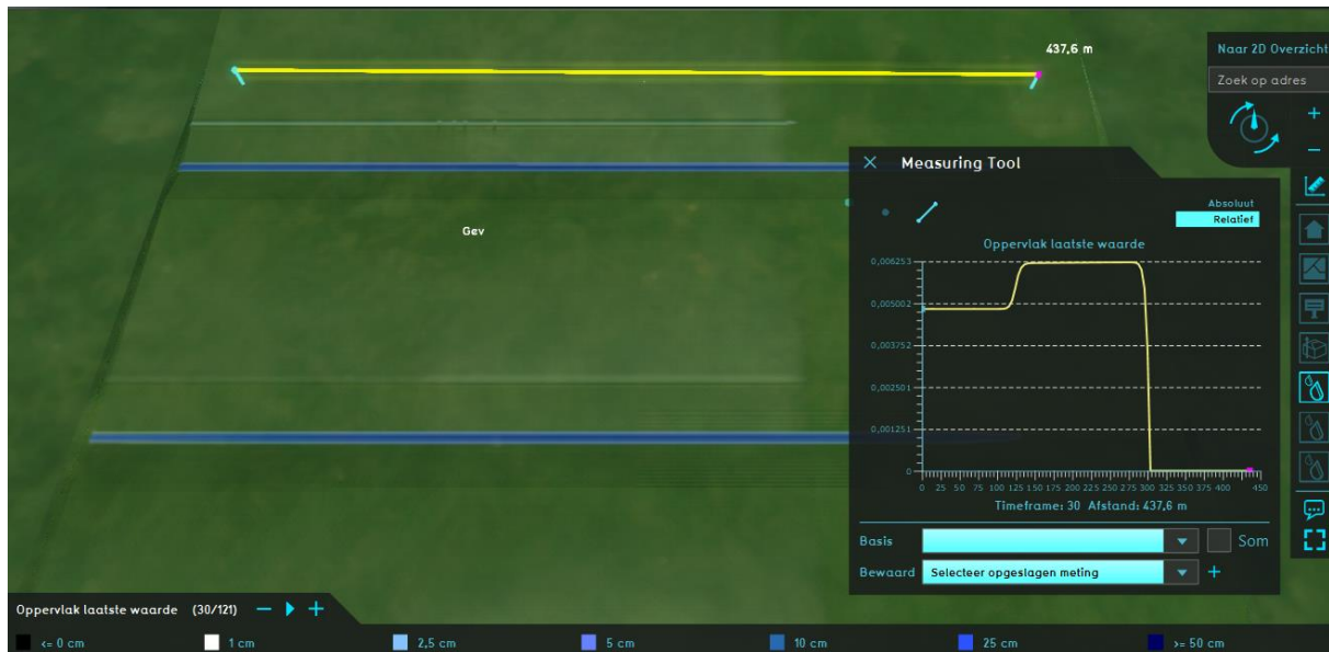
Figuur 25: Waterdiepte op maaiveld 29 minuten na regenbui
