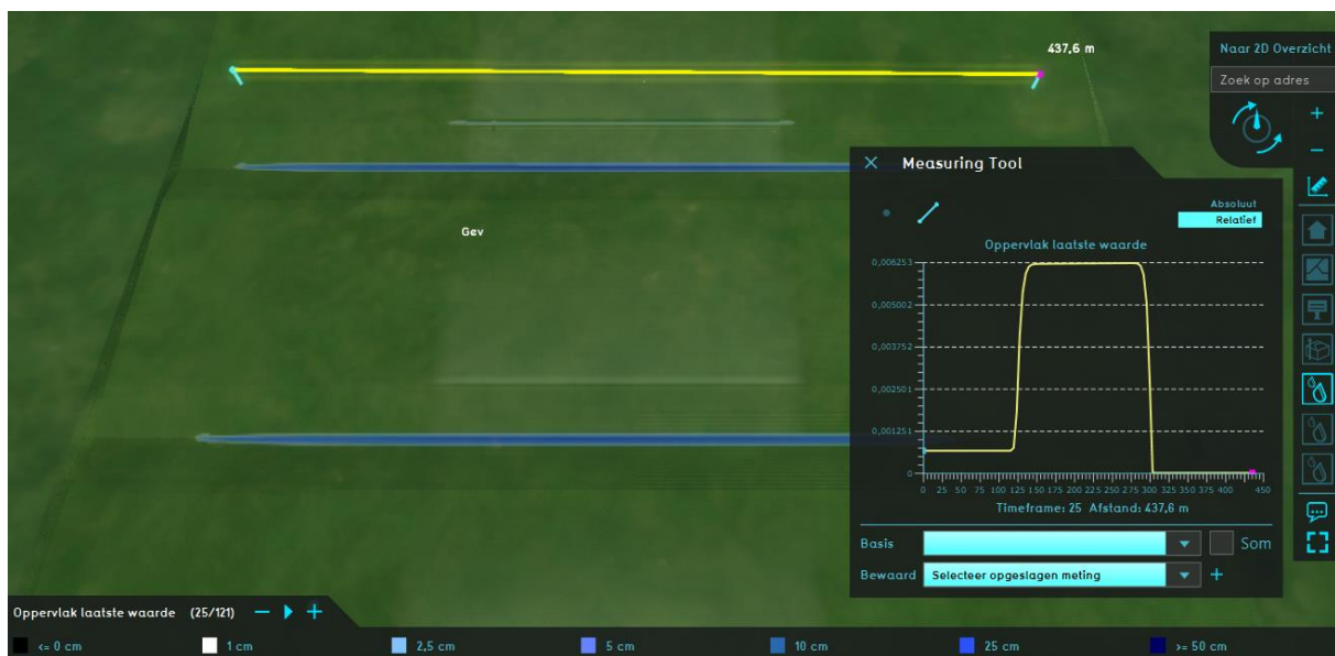
Figuur 24: Waterdiepte op maaiveld 24 minuten na begin regenbui
