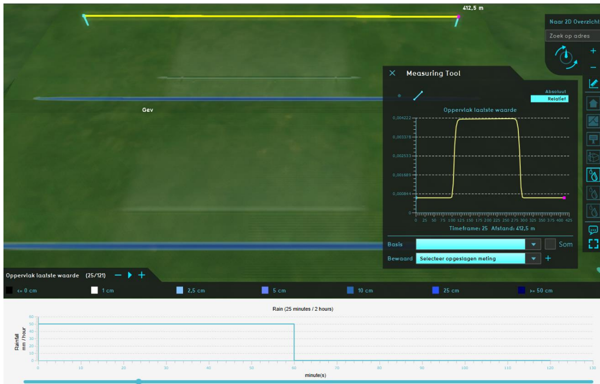
Figuur 27: Waterdiepte op maaiveld bij verschillende vegetatiedichtheden 24 minuten na het begin van de regenbui
