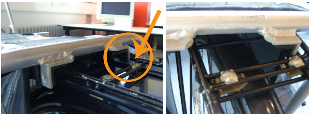
Figuur 34: Het eerste prototype dat scheef over het opzetstuk schuift en daardoor blijft haken
