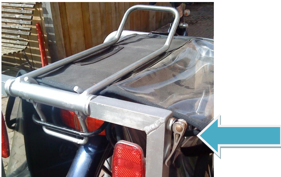
Figuur 30: Het prototype vergrendeld aan de fiets
