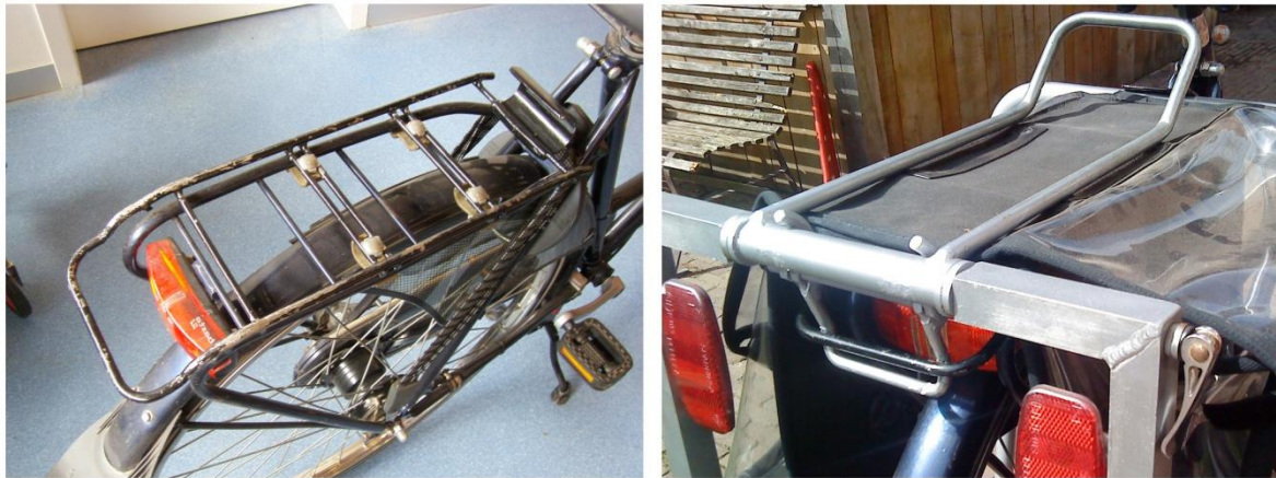
Figuur 32: Vergrendeling door uiteinde van hendel tegen het opzetstuk te klemmen
