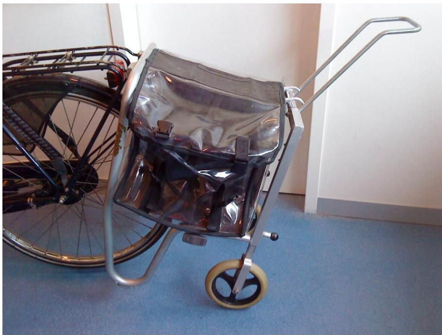
Figuur 6: Door middel van kantelen wordt de Fietskar op de fiets gereden
