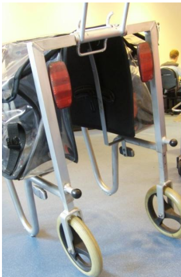
Figuur 26: De poten op ongelijke hoogte tijdens het verstellen van de hoogte
