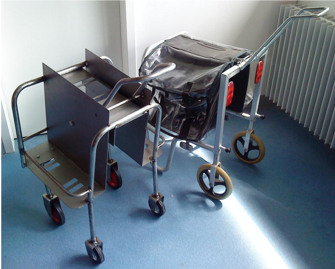
Figuur 52: Links het nieuwe prototype met mechanisme, rechts de oudere variant
