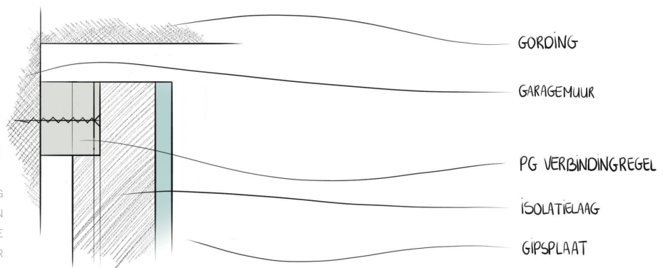
FIGUUR 5.18.A > BEVESTIGING VAN DE BOVENZIJDEN VAN HET WANDPANEEL AAN DE GARAGEMUUR
