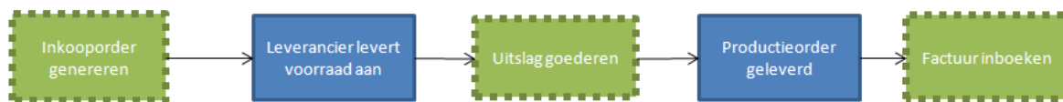
Figuur 18: Proces binnen het ERP-systeem voor de producten van Hensel. Hierin zijn de blokken met gestippelde randen de blokken waar in BAAN wordt gewerkt.
