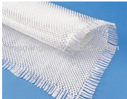
FIGUUR 6 GLASVEZELS WEEFSEL, NOG NIET GEÏMPREGNEERD
