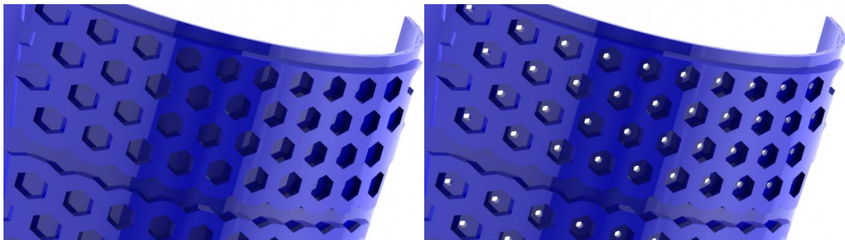
Figuur 33 - Een afbeelding van de verpakking zonder (links) en met (rechts) gaten in de zeshoeken.
