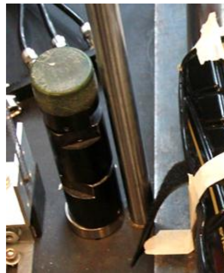
Figuur 50 - Een afbeelding van de stopper (links) naast een van de verticale staven van de impact tester (midden). Rechts is een stuk van een van de scheenbeschermers te zien.
