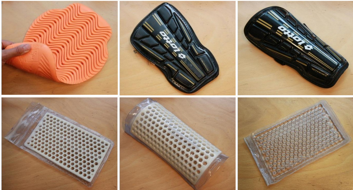
Figuur 42 - Foto's van alle monsters. Van links naar rechts, van boven naar beneden: D3O, Lotto plat, Lotto krom, Prototype plat, Prototype krom en Prototype water.
