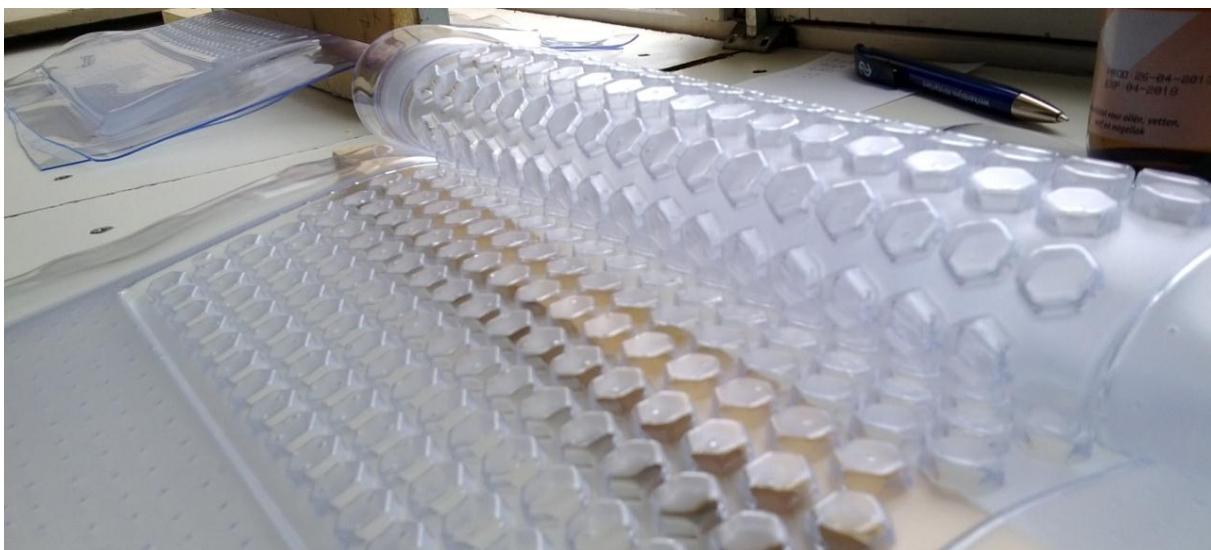
Figuur 36 - Twee vellen ge-thermovormd PVC welke al deels op elkaar gelijmd zijn.
