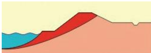
Figuur 15 Instabiliteit voorland
