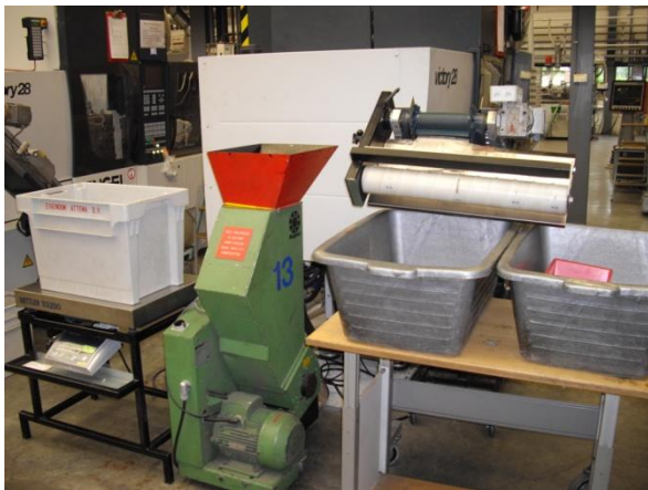
Figuur 4-2: Maalmolen naast een spuitgietmachine
