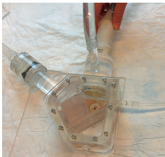
Figuur 25: Positie van de probe tijdens het in beeld brengen van de mitralisklep
