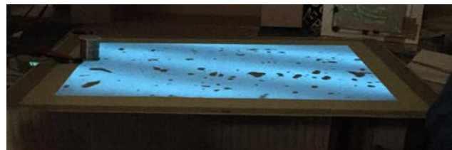
Figuur 6 - Een testpaneel dat is gemaakt vóór de start van de bacheloropdracht. Deze proef is door Xcite gedaan om te kijken of er grote oppervlakten kunnen worden gemaakt. Er zijn veel onzuiverheden te zien in het oplichtende paneel.
