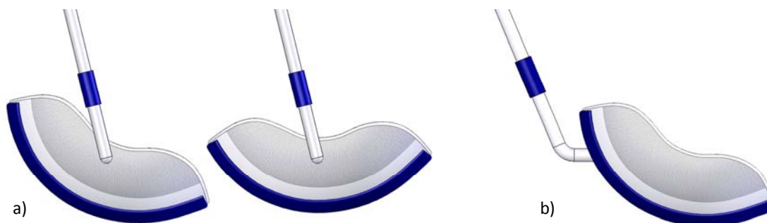
Figuur 46: a) Het opzetstuk kan via de zijkant aan de stok worden bevestigd en is in stand verstelbaar b) Het opzetstuk kan aan de achterkant aan de stok worden bevestigd en is niet in stand verstelbaar
