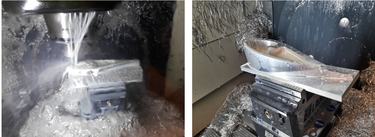
Figure 4.10: CNC milling of the parts at the University of Twente's "Techno Centrum voor Onderwijs en Onderzoek" (TCO).
