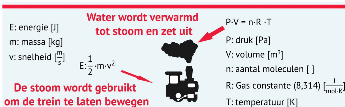
Figuur 2.8: Bij een stoomtrein wordt chemische energie (kolen) omgezet in warmte en druk waardoor de trein uiteindelijk kinetische energie krijgt.
