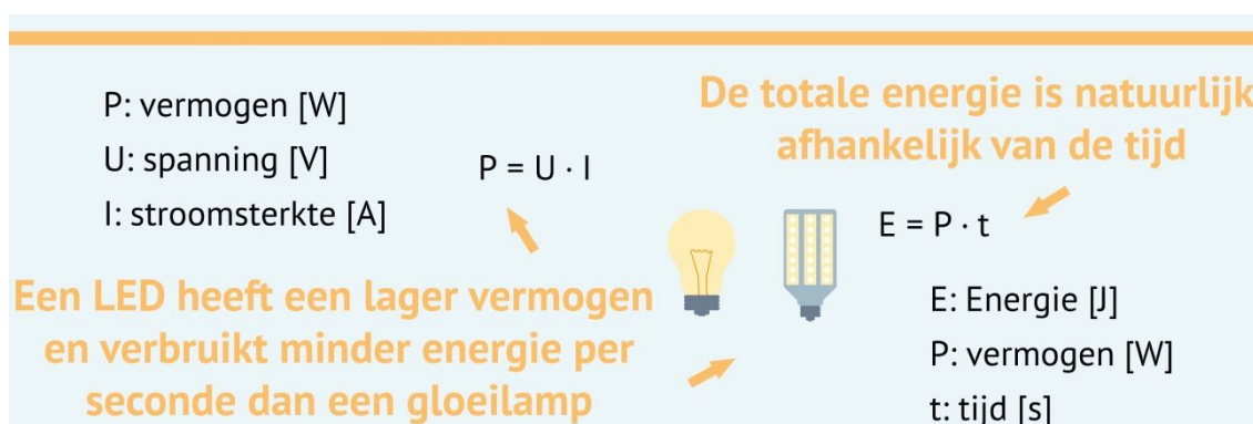
Figuur 3.3: LED lampen hebben een lager vermogen dan gloeilampen terwijl ze evenveel licht uitzenden.
