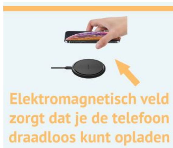
Figuur 3.5: Dankzij elektromagnetisme kan je je telefoon draadloos opladen.
