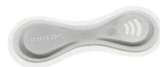
Figuur 1: Philips biosensor patch voor continue monitoring van hartslag en ademhalingsfrequentie
